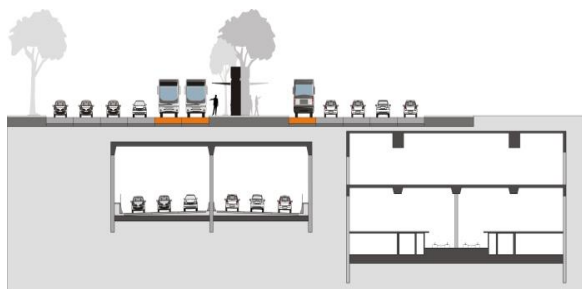
Figura 13 - Corte do túnel da Av. Central e do metrô
