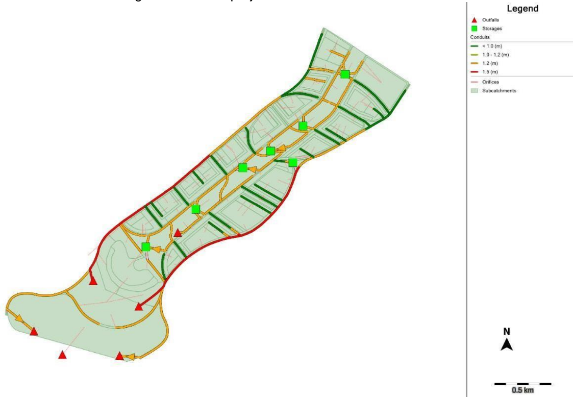
Figura 8 - Rede de drenagem tradicional projetada
