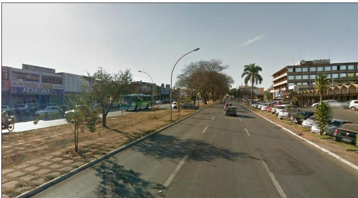
As vias transversais à Via W3 Sul são classificadas como vias coletoras, com três faixas de rolamento e velocidade de 40 km/h.
