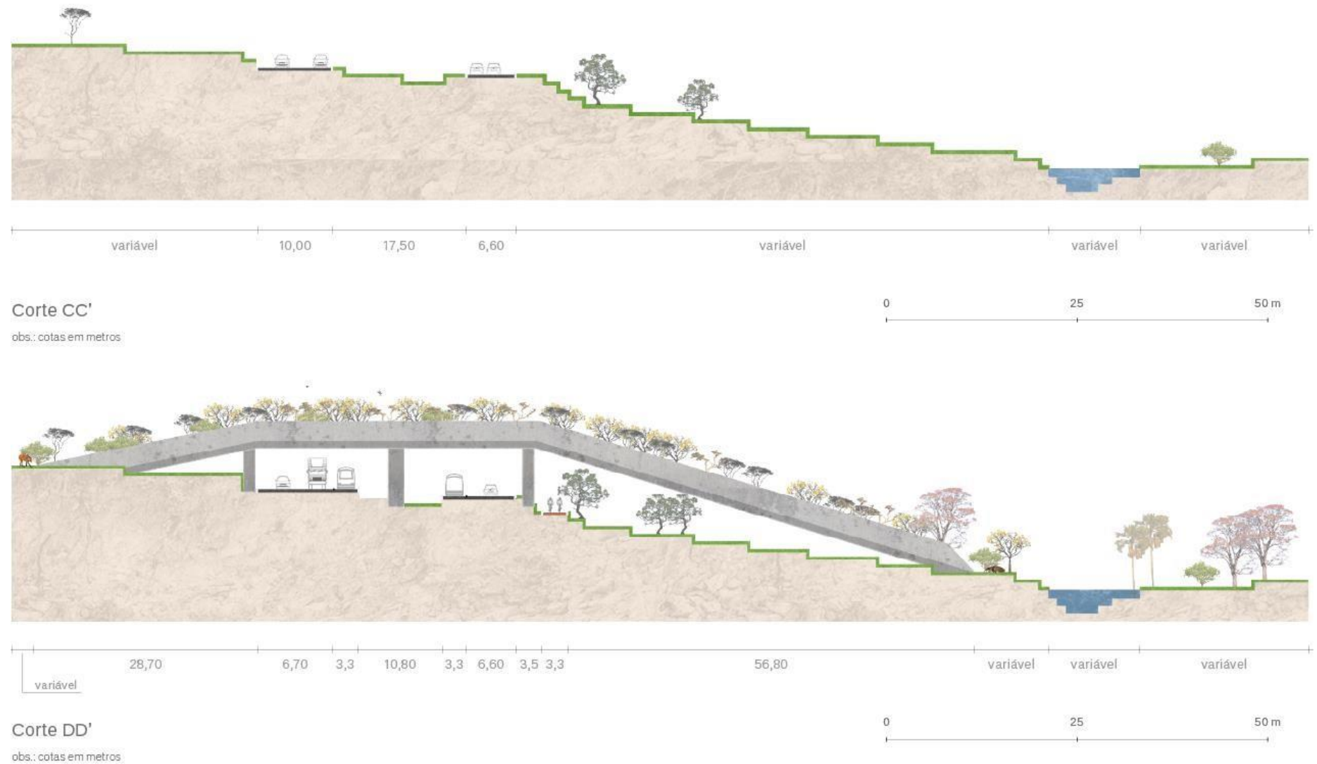
Figura 21 - Perfil viário existente e perfil viário projetado na região do córrego Corguinho
